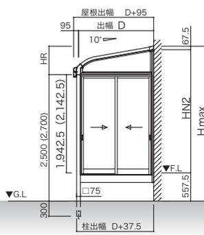
側面図 ■規格寸法図【Fタイプ】
