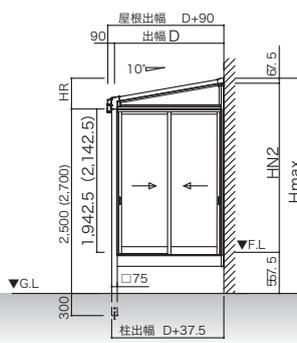
(注) 出幅9尺は2枚掃出しサッシではなく、4枚掃出しサッシになります。
