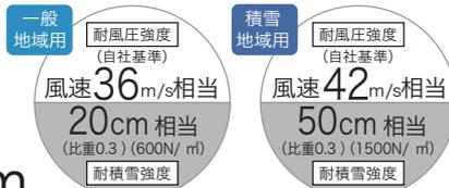
耐積雪最大50cm、耐風圧最大Vo=42m/秒相当 ※屋根部のみ
